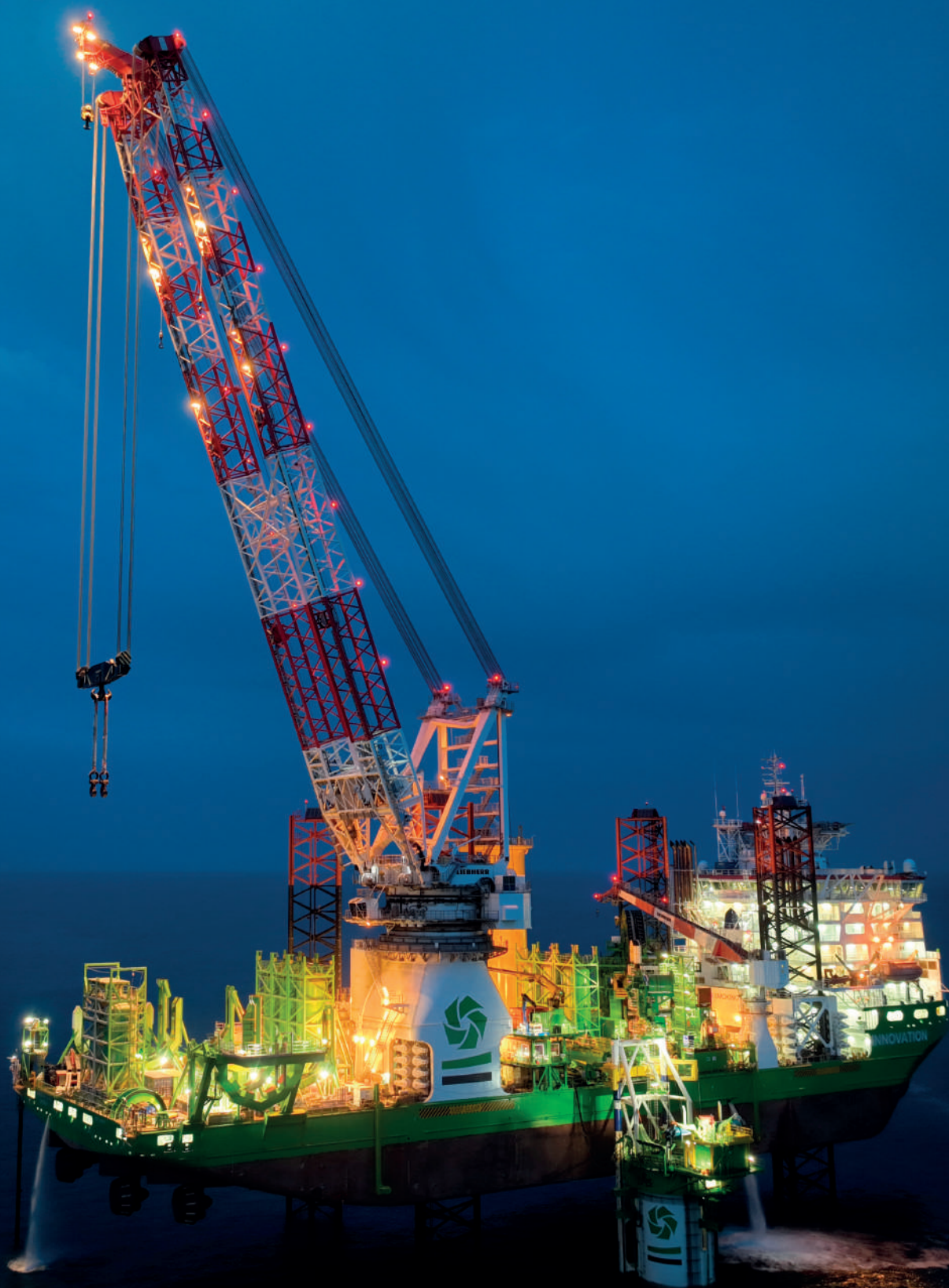
'Innovation' uitgerust met offshore funderingsboor.
